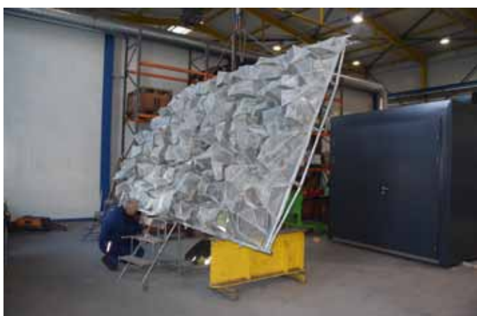
Die drei grossen Schartentarnungstore werden fertig mit Drahtgeflecht bezogen.
