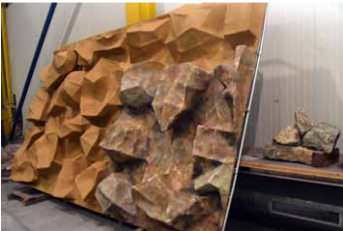
Gemäss dem Muster aus Origanl-Albulagrinit werden die Tore bemalt.
